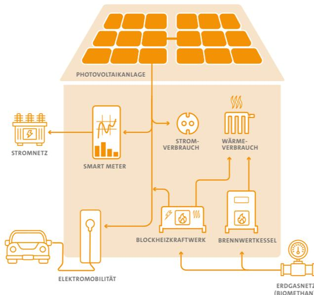
Aus dem Erdgasnetz beziehen wir ausschließlich Biomethan. Mittels eines Blockheizkraftwerks wird Strom und Wärme erzeugt. Unterstützend dazu erzeugt die Photo-
